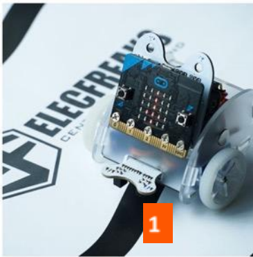
Robot ring:bit Car de la société ElecFreaks équipé du module suiveur de ligne (Rep1)
